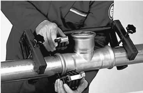
Slika 41: Namještanje obujmice za stiskanje uz korištenje pomoćne spone
