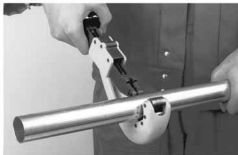
Slika 15: Skraćivanje dužine nožem za rezanje cijevi
