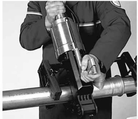
Slika 41: Namještanje obujmice za stiskanje uz korištenje pomoćne spone
