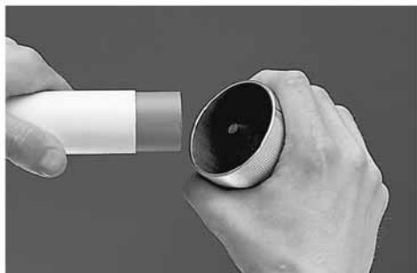
Slika 33: Vanjsko i unutarnje skidanje rubova cijevi iz C-čelika s ručnim skidačem rubova
