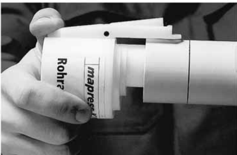
Slika 31: Mapress alat za odstranjivanje plašta za bakar \varnothing 35 - 54 mm
