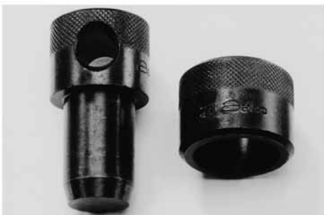
Slika 19: Trn i obruč za kalibriranje
