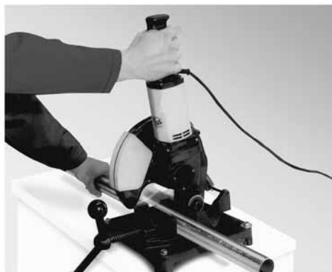
Slika 16: Skraćivanje dužine s mehaničkom pilom s električnim motorom
