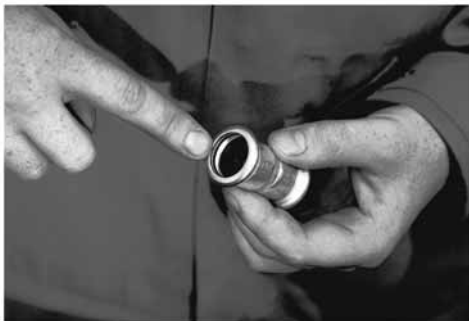
Slika 23: Provjeravanje brtvenog prstena
