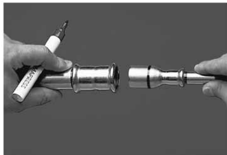
Slika 22: Označavanje dubine umetanja na spojnom elementu za stiskanje s dijelom za umetanje
