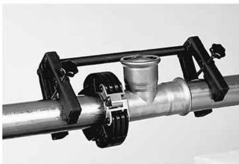
Slika 26: Sigurna montaža za vodoravan cjevovod
