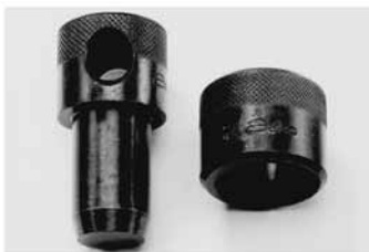
Slika 35: Trn i obruč za kalibriranje
