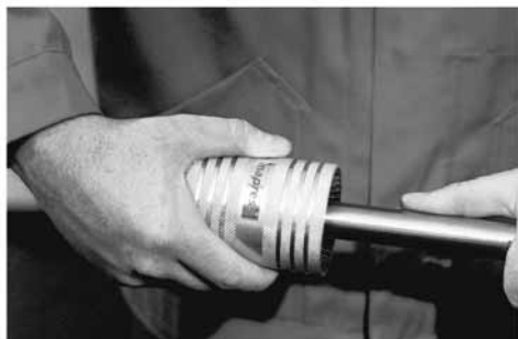
Slika 17: Vanjsko skidanje rubova s ručnim skidačem rubova
