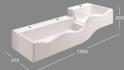
UMIVAONIK B 1390 / H 300 / T 415 za tri armature, niže korito lijevo, materijal: Varicor® otvor za armaturu u sredini, lijevo i desno, bez preljeva bez otvora za armaturu, bez preljeva
